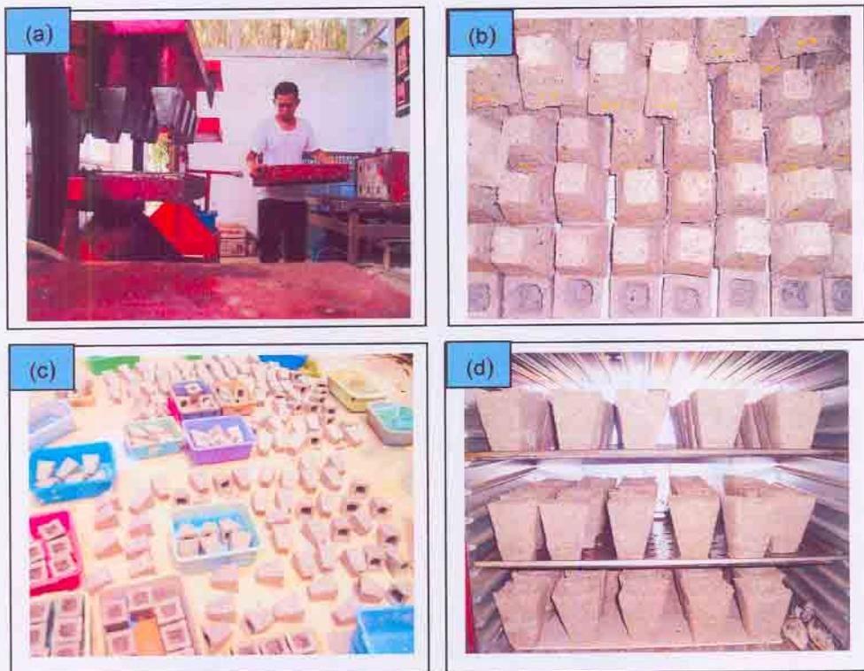
Gambar 5 Tahapan pencetakan WSRL; pencetakan (a), kering angin (b), penjemuran (c), dan oven (d)
