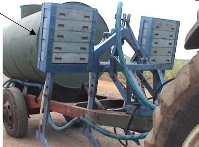
Gambar 2. Penambahan pemberat pada rangka pembuka alur
