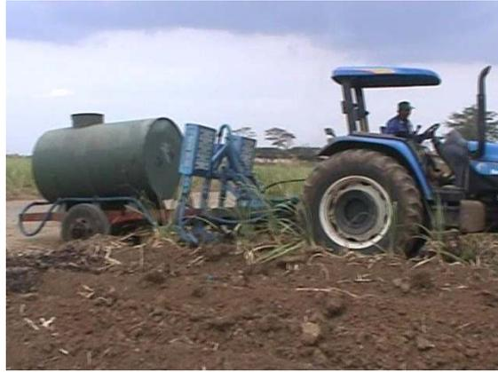
Gambar 8. Pemasangan pemberat pada saat pengujian
