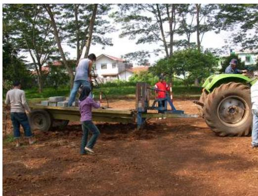
Gambar 6. Proses pengujian aplikator pupuk cair
