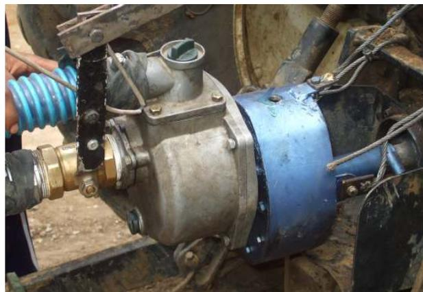
Gambar 4. *Gear box* dan pompa dipasang langsung pada PTO
