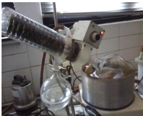
Gambar 6 Ekstraksi dengan rotary evaporator
