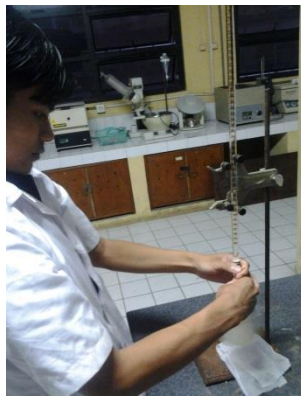
Gambar 11 Proses pencarian bilangan peroksida.
