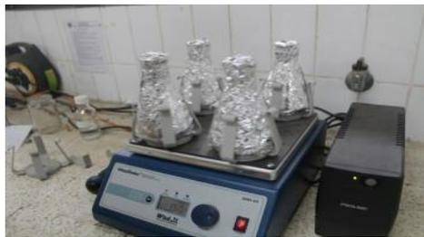
Gambar 8 Maserasi *Caulerpa racemosa* dengan etil asetat dengan *orbital shaker*
