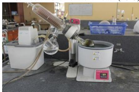
Gambar 10 Evaporasi *Caulerpa racemosa* dengan *rotary evaporator*
