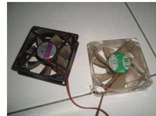
Gambar 2 Kipas angin untuk meratakan suhu ruang
