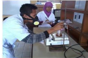
Gambar 5. Proses ekstraksi abu layang
