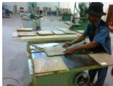
Gambar 4. Proses pabrikasi (pemotongan papan partikel)
