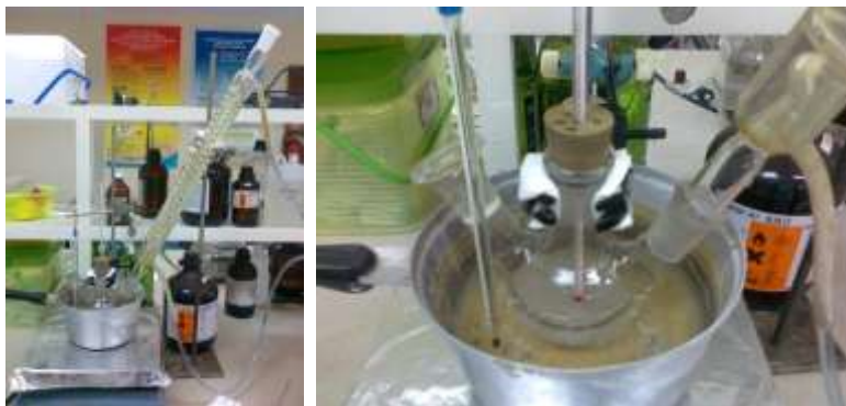
Gambar 6. Rangkaian alat sintesis GlcN.
