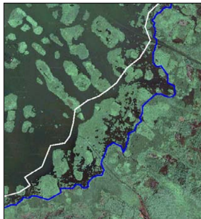
Gambar 8. Perbandingan batas permukaan air danau tanpa vegetasi air dari data SPOT (garis putih) dan batas permukaan air danau dari data IKONOS (atas) pada citra IKONOS
