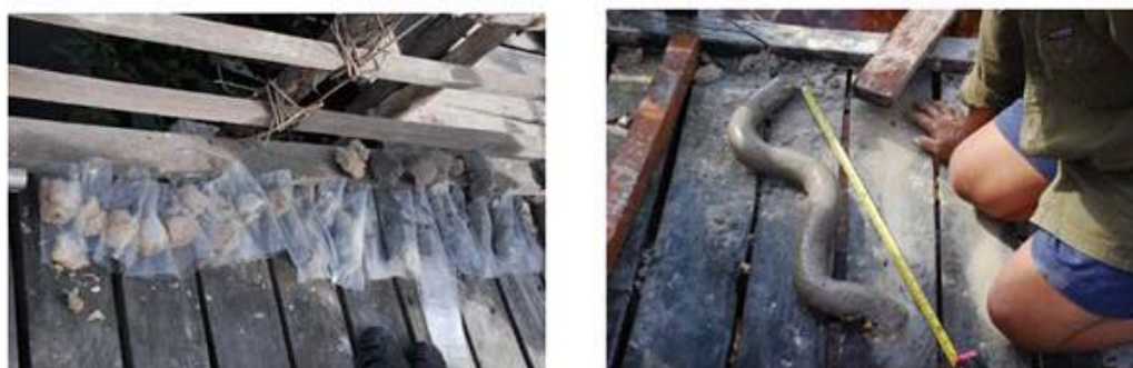
Gambar 6 ad dan b. Contoh lempung dari pemboran inti di desa Semangit, Danau Sentarum.
