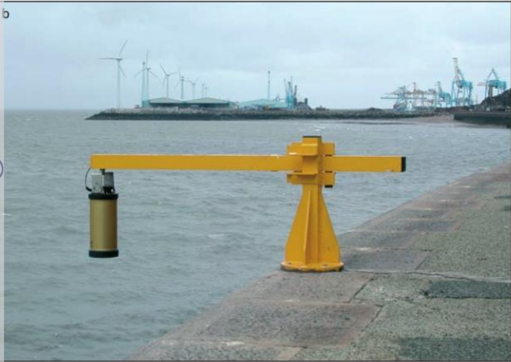
Gambar 4. Uji coba OTT Kalesto ( radar gauge ) di Liverpool (IOC, 2006)
