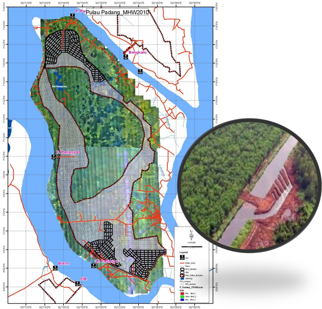
Gambar 2. Tata letak Saluran Drainase di Kawasan Budidaya Lahan Gambut dan Gambar Peat dam + Spillway
