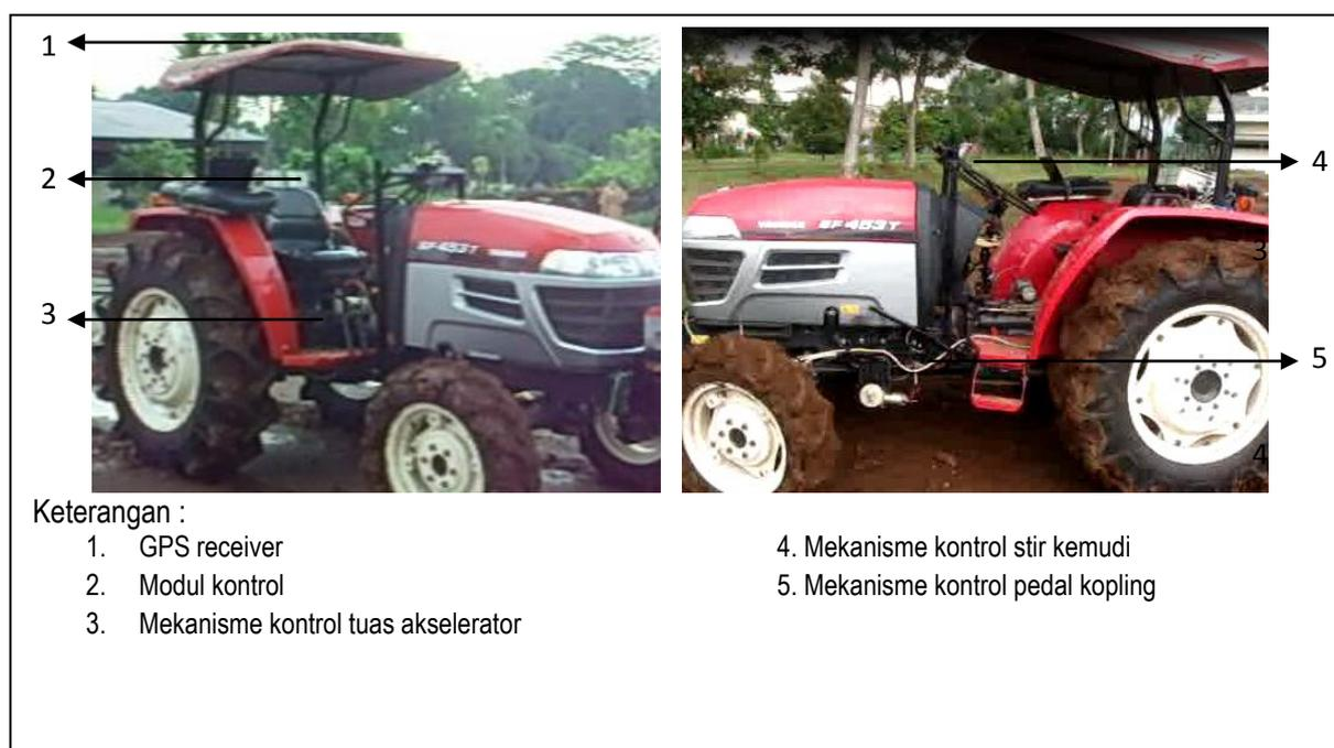
**Gambar 2.** Tampilan alat secara keseluruhan
