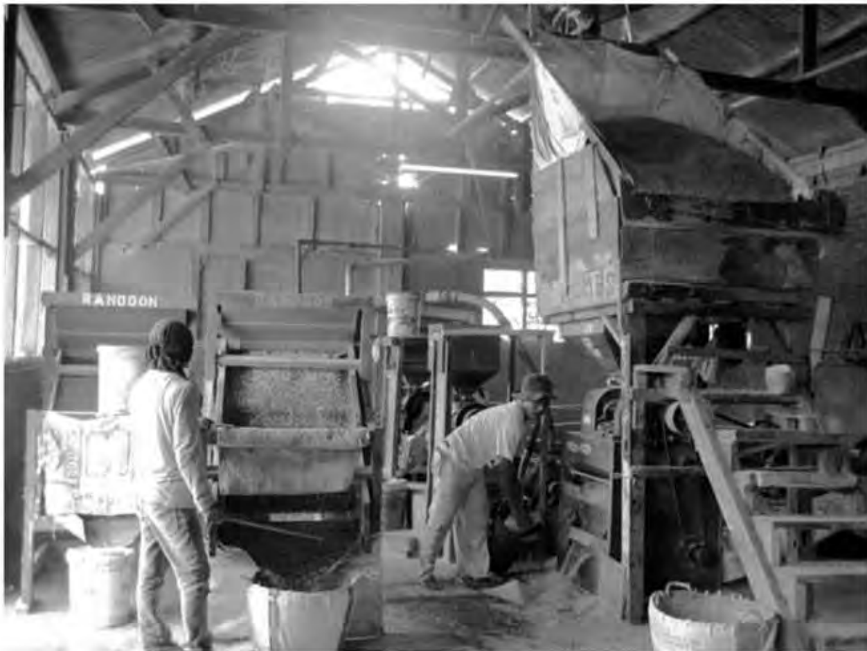
Gambar 1. Unit penggilingan padi yang digunakan dalam penelitian, terdiri dari husker, separator dan polisher
