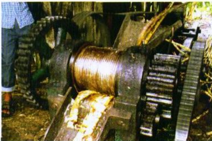
Gambar 3. Proses pengepresan tebu untuk mendapatkan nira tebu dengan menggunakan mesin press tiga silinder yang digerakan motor bertenaga diesel.
