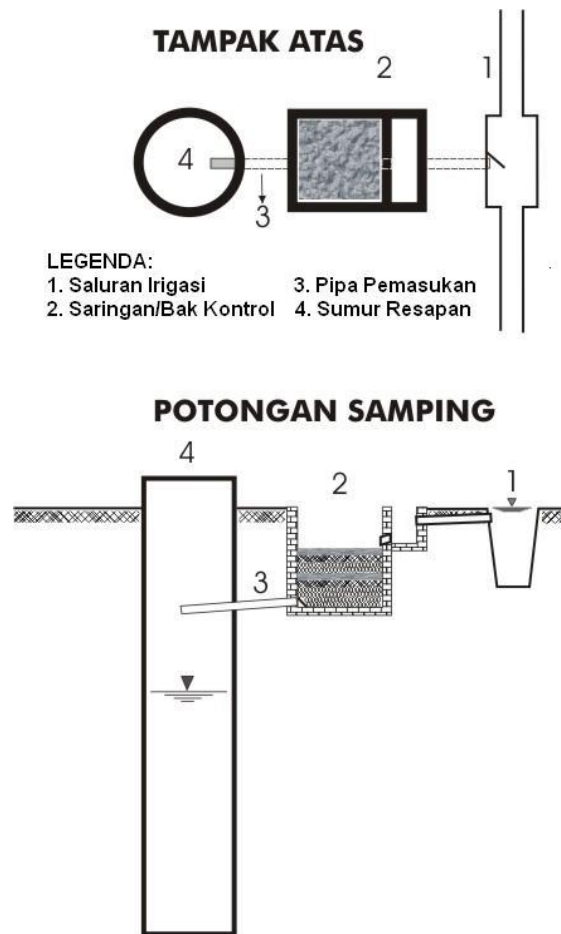
Gambar Teknis Sumur Resapan
