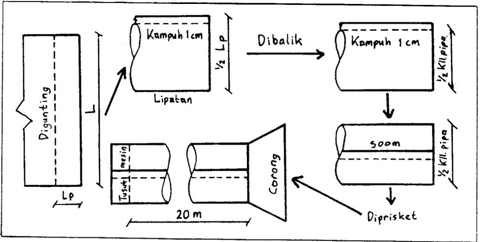
Gambar 4. Skema pembuatan pipa pipih tipe A
