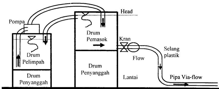
Gambar 1. Skema peralatan percobaan pada head 1,8 m
