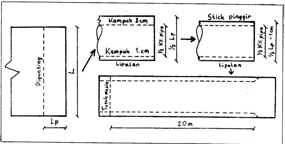
Gambar 5. Skema pembuatan pipa pipih tipe B
