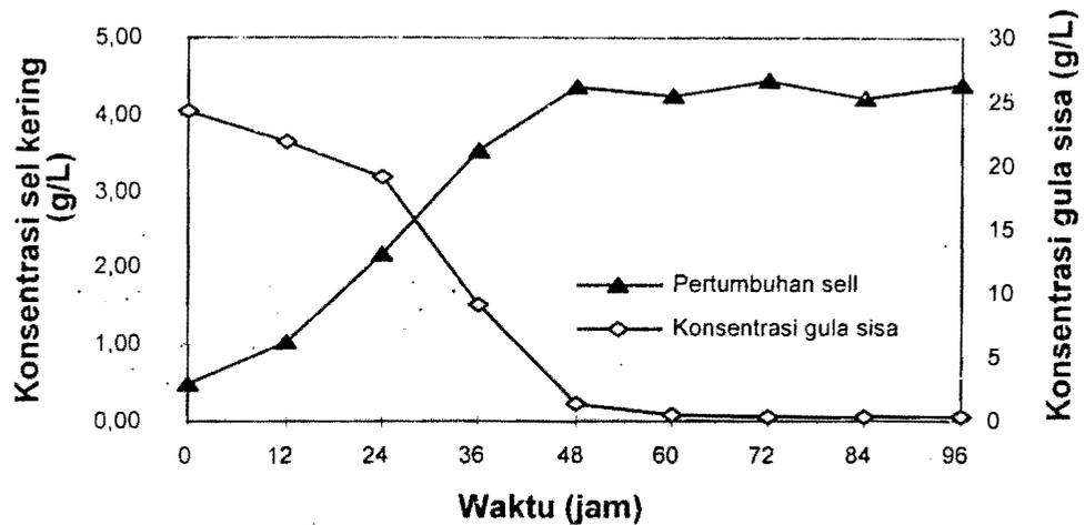
Gambar 1. Kurva pertumbuhan dan pola konsumsi substrat oleh *R. eutropha* pada kultivasi *batch* (skala fermentor 2 L) dengan konsentrasi gula 30 g/L, rasio C/N 10:1
