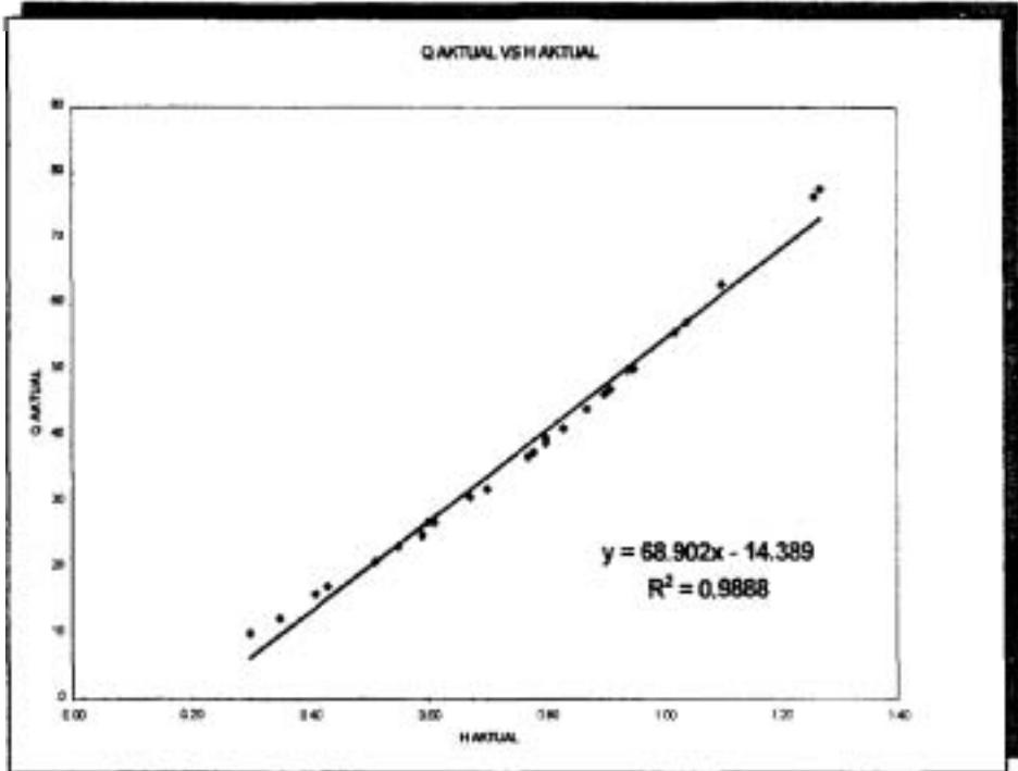
Gambar 9. Kurva Hubungan antara H Aktual Dengan Q Aktual
