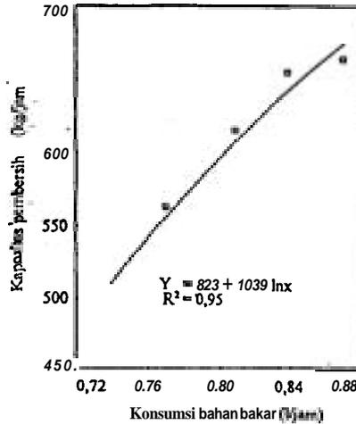
Gambar 3. Hubungan antara konsumsi bahan bakar dengan kapasitas pembersihan
