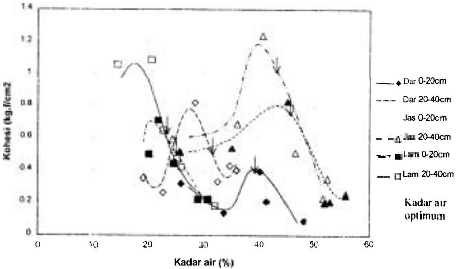
Gambar 3. Hubungan antara kohesi dengan kadar air pematatan hasil uji geser langsung
