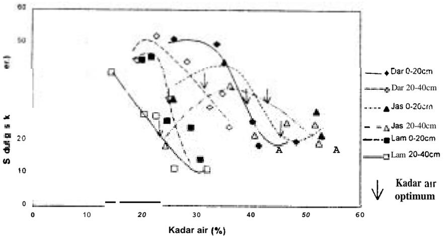
Gambar 4. Hubungan antara sudut gesekan dalam dengan kadar air hasil uji geser langsung
