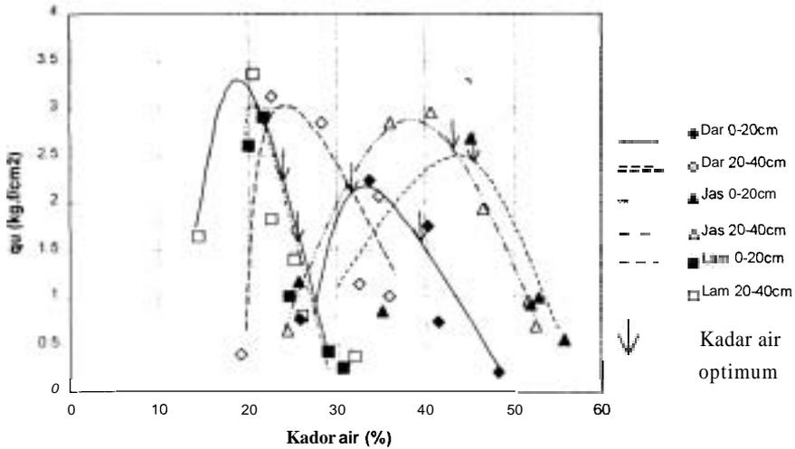
**Gambar 2.** Kurva hubungan antara kadar air dengan  $q_u$
