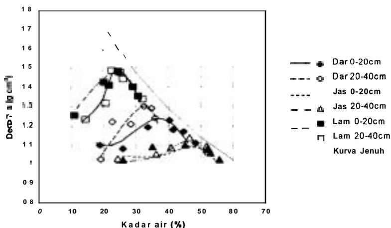
Gambar 1. Kurva karakteristik pemadatan tanah
