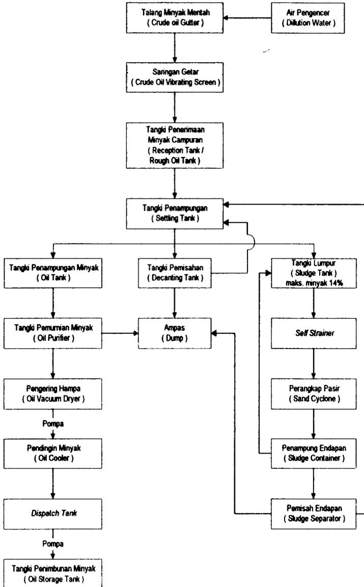
Gambar 1. Diagram Alir Proses Penjemihan Minyak Kelapa Sawit
