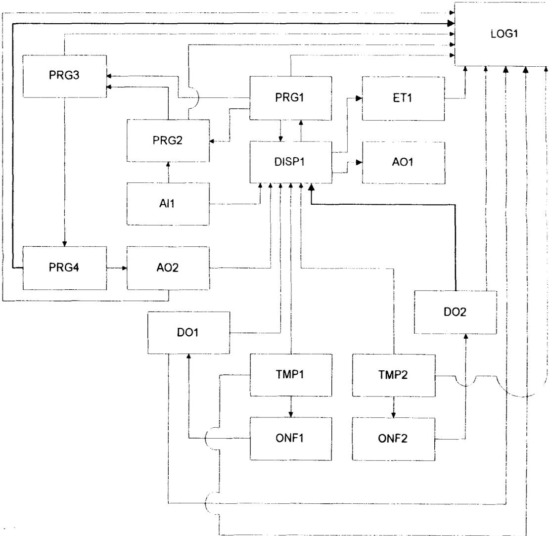
Gambar 12. Diagram Alir Proses Pengontrolan Proses Pencampuran
