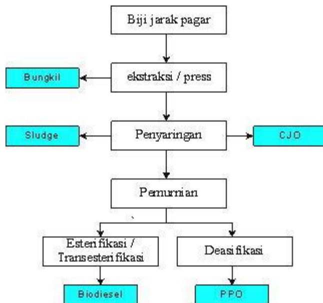
Gambar 2. Proses pengolahan jarak pagar menjadi bahan bakar cair.
