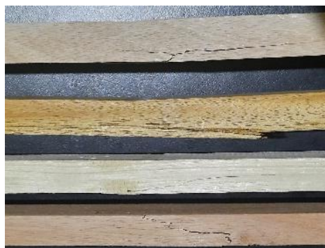
Gambar 1 Kerusakan Kayu setelah pengujian lentur
