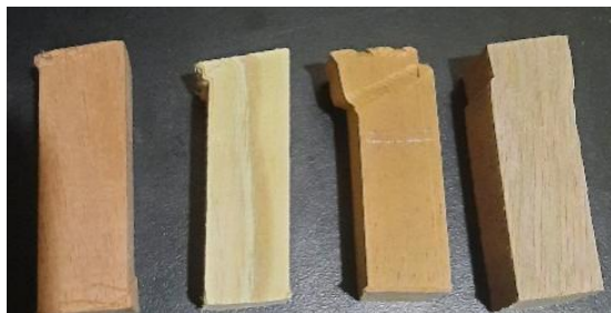
Gambar 2 kerusakan setelah pengujian keteguhan tekan sejajar serat
