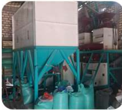
Gambar 55 Mesin pembersih gabah (grain cleaner) kapasitas 2 ton per jam (Suwarto et al. , 2025)
