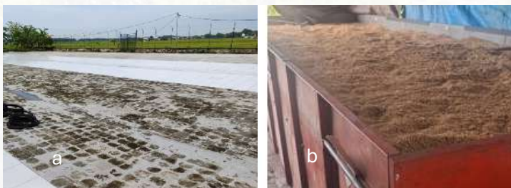
Gambar 54 Lantai jemur (a) dan box dryer kapasitas 5 ton (b)
