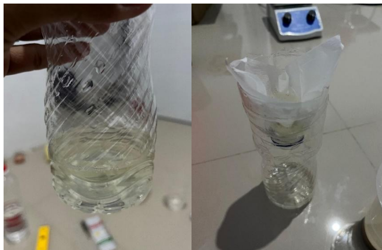
Gambar 5 Pembuatan Larutan, (a) larutan biokoagulan, (b) penyaringan larutan
