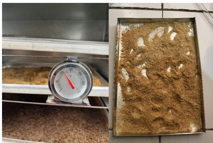
Gambar 4 Proses Pengeringan, (a) pengovenan, (b) hasil oven
