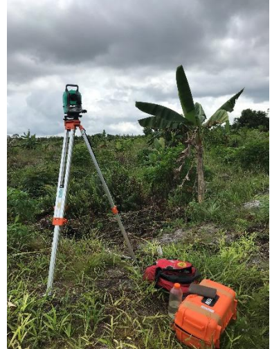
Gambar 8. Penempatan Theodolite di lapangan. Foto: Wahyu Iskandar
