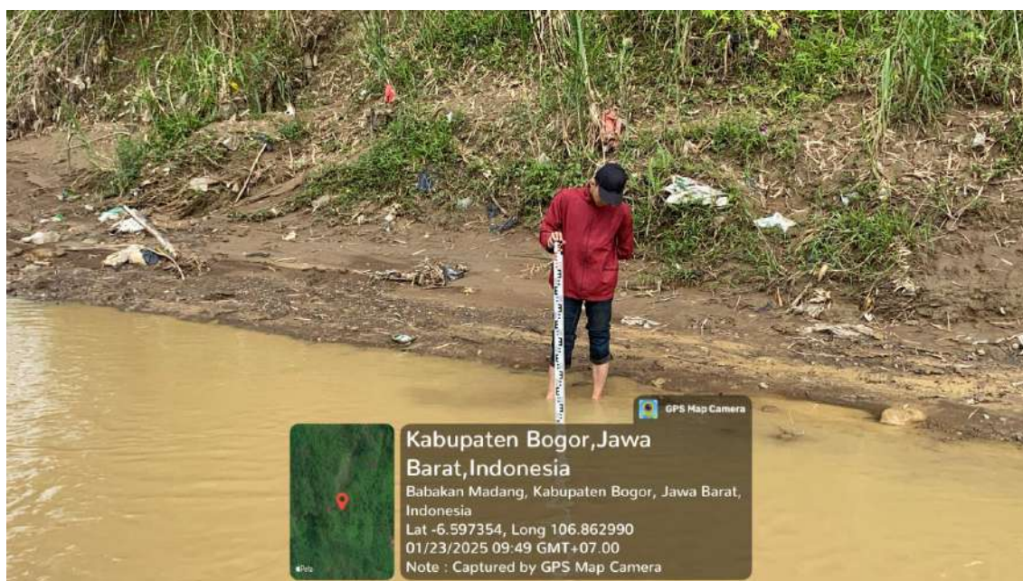
Gambar 22 Pengukuran kecepatan aliran sungai
