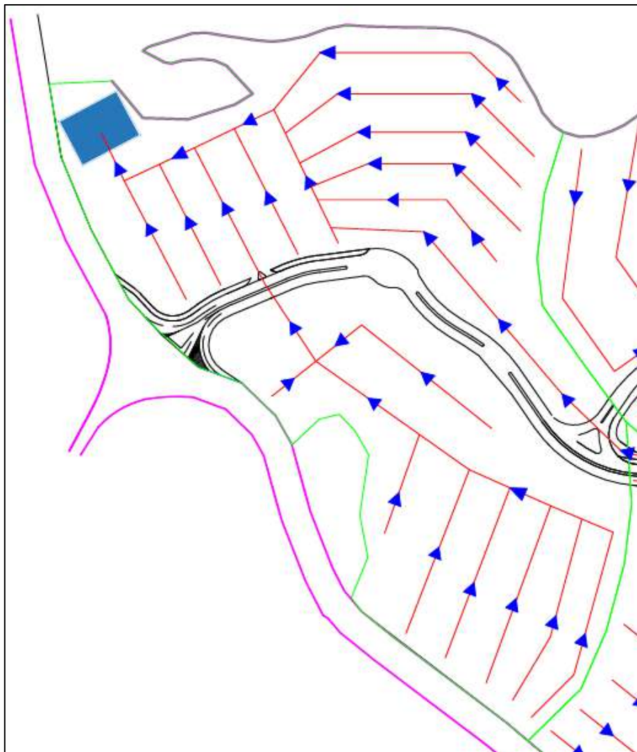
Gambar 35 Skema Pengaliran Drainase pada DTA 1
