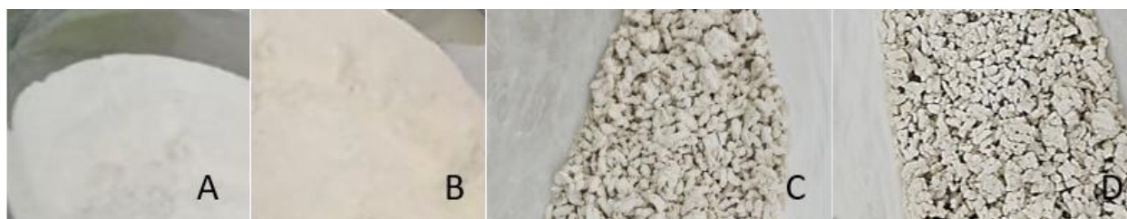
Gambar 2. Produksi sampel (A) \text{CaO}_2 powder, (B) \text{CaO}_2 -PAA powder, (C) \text{CaO}_2 granule, (D) \text{CaO}_2 -PAA granule
