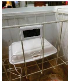
Gambar 24 Pemasangan termometer pada *freezer* penyimpanan bahan baku dan produk di sarana produksi UMKM Dapur Umak setelah dilakukan perbaikan penerapan CPPOB
