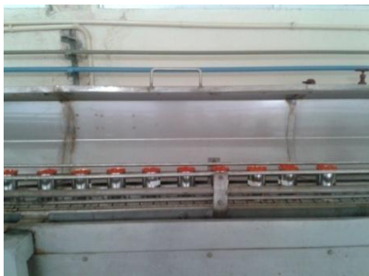
Proses exhausting cabai giling dalam kaleng
