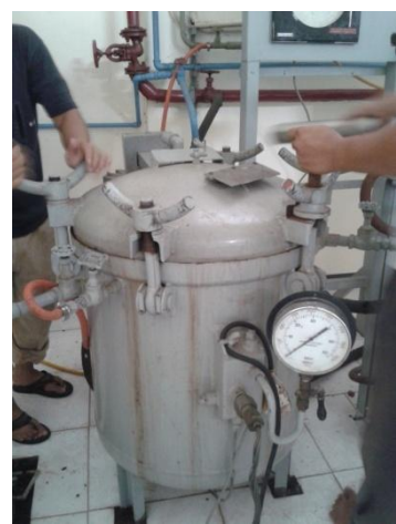
Retort ditutup rapat untuk proses sterilisasi
