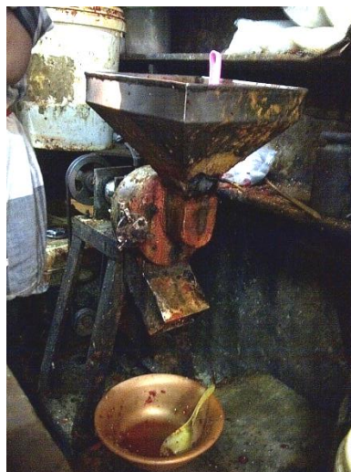
Gambar 3. Alat penggiling cabai di pasar
