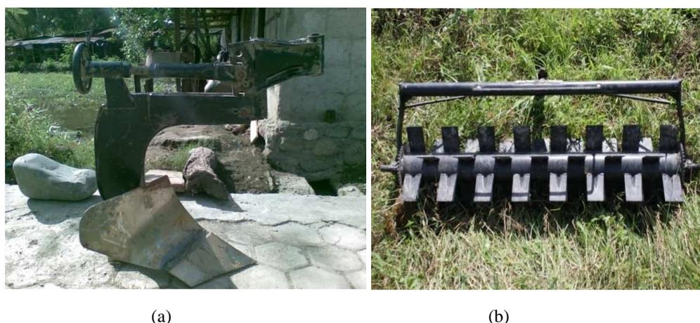
Gambar 9. (a) Bajak singkal dan (b) Gelebeg yang digunakan pada traktor
