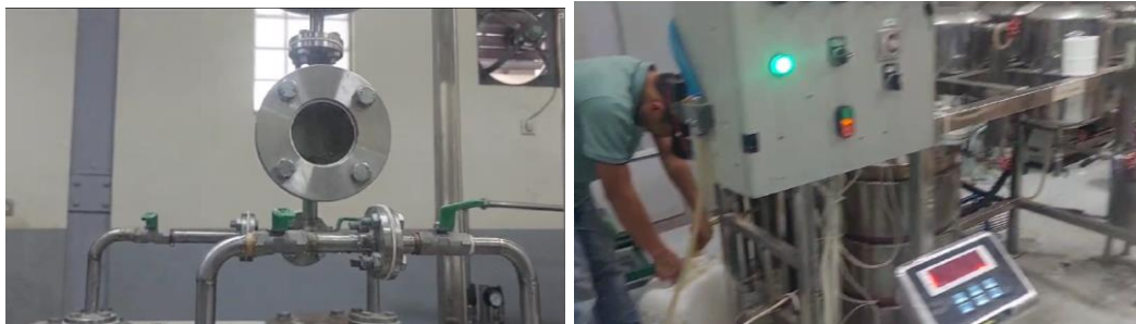
Gambar 1. Validasi Proses Deterpenasi menggunakan Alat Distilasi Fraksinasi Vakum berkapasitas 50 kg/batch
