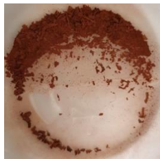
Gambar 2 Tembaga oksida hasil sintesis melalui reaksi seperti-Tollens
