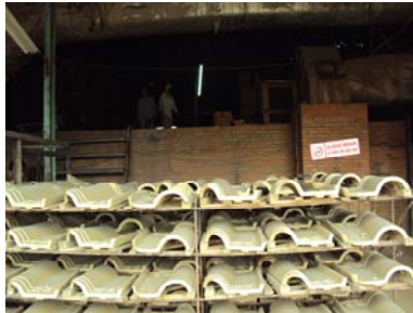
b. Hasil produksi genteng gelombang setengah matang
