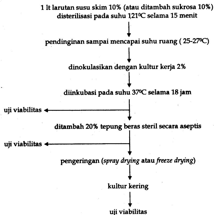
Keterangan: proses *spray drying* yang digunakan adalah pada suhu outlet 80°C dan inlet 190°C selama 1 detik, sedangkan *freeze drying* menggunakan suhu -98°C selama 48 jam dengan tekanan 760 mmHg.
