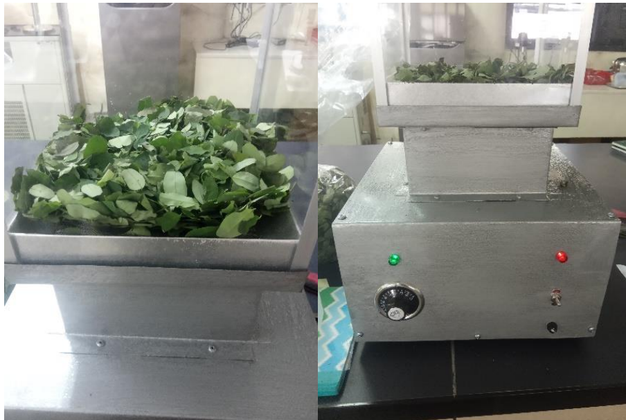
Gambar 9 Pengeringan daun kelor menggunakan fluidized bed dryer
