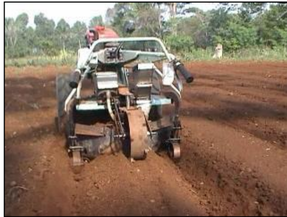
Gambar 6 Prototipe-1 mesin penanam dan pemupuk jagung saat dioperasikan (Hermawan, et al., 2009).
