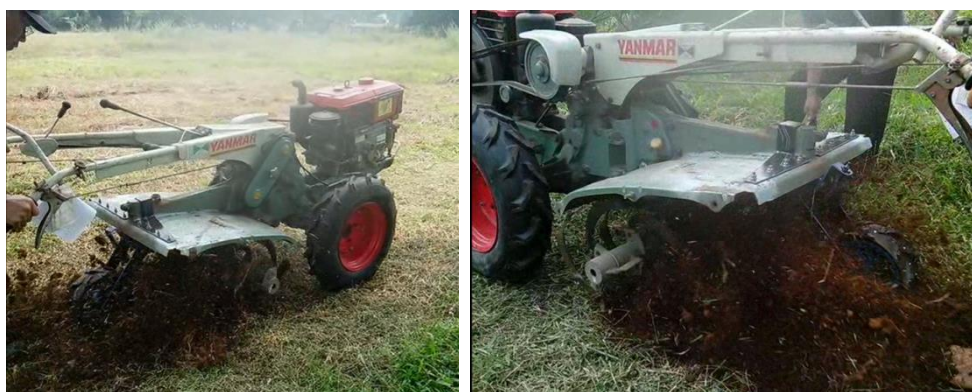
Gambar 16 Pengujian rotary tiller pada tanah keras.
