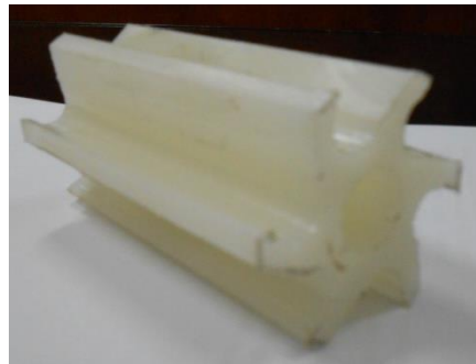
Gambar 30 Konstruksi unit penjatah pupuk.
