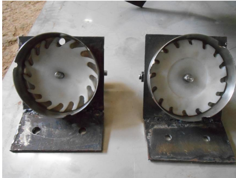
Gambar 29 Konstruksi unit penjatah benih jagung.
