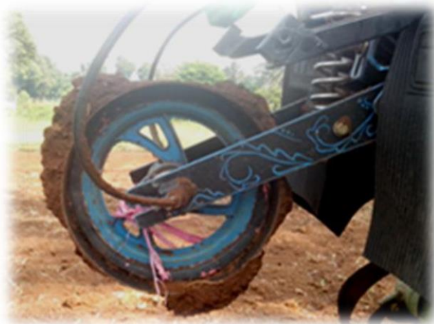
Gambar 23 Tanah yang melekat pada roda penggerak
