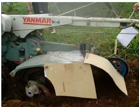
Gambar 19 Percobaan penutup samping dan belakang rotary tiller .
