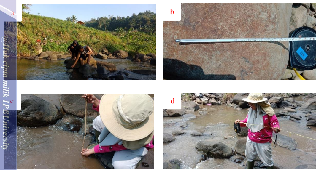
Keterangan : a. Pengukuran suhu air, b. Pengukuran suhu udara, c. pengukuran tinggi air, dan d. Pengukuran panjang sunagi
