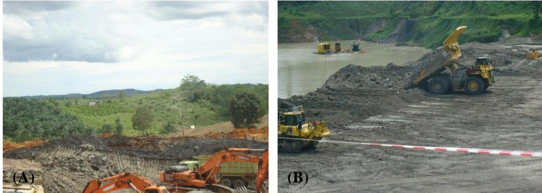
Gambar 23 (A) Proses pembukaan lanskap untuk kegiatan penambangan; (B) Proses penutupan *pit* tambang untuk pembenahan lanskap pascatambang.
