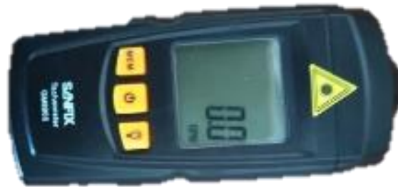
Gambar 27 Tachometer yang digunakan dalam penelitian
