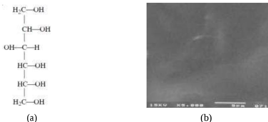
Gambar 14 (a) Struktur kimia sorbitol dan (b) Hasil foto SEM pada permukaan edible film dengan perbesaran 5000x. Sumber: Soesilo et al. (2005) dan Wijaya (2013)
