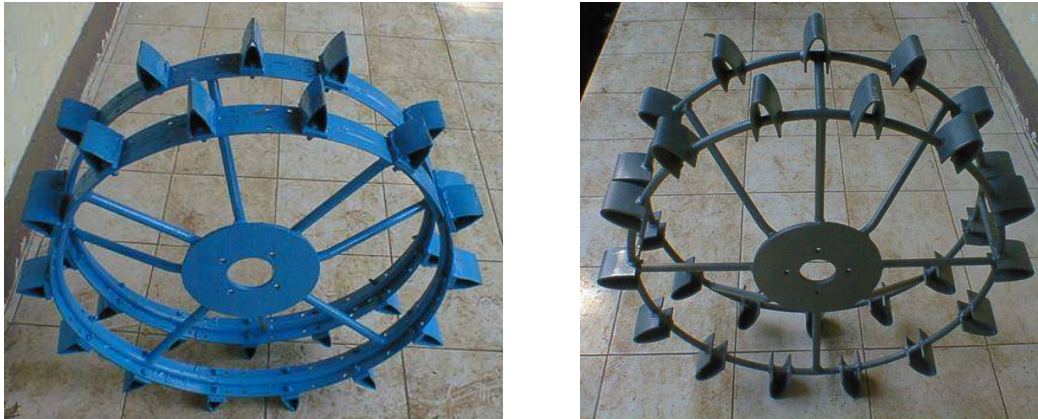
Gambar 7. Roda besi prototip ideal (kiri) dan prototip industri (kanan)
