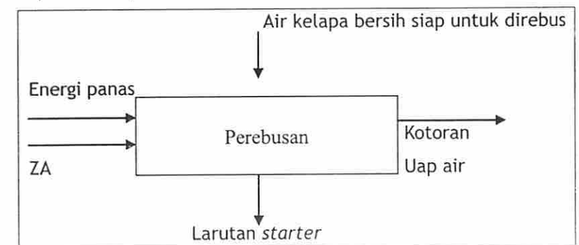
Gambar 79. Sistem Kesetimbangan Massa pada Proses Perebusan
