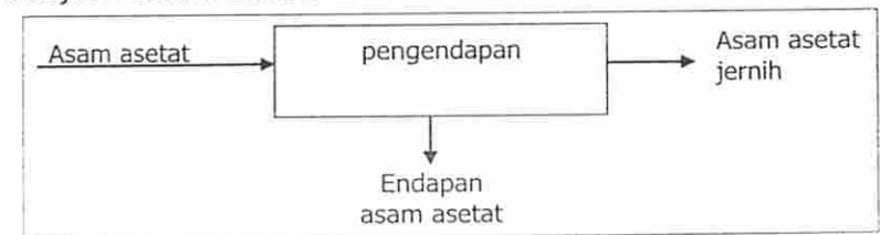
Gambar 112. Sistem Keseimbangan Massa pada Proses Pengendapan.
