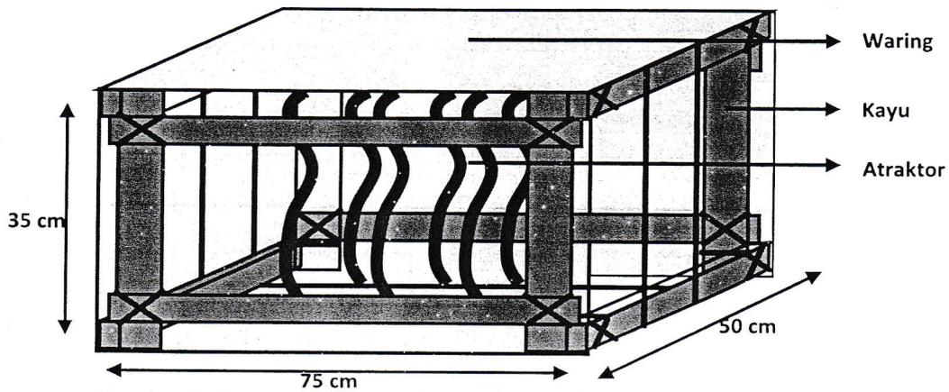
Gambar 2. Desain kotak penutup waring untuk tahap pertama
