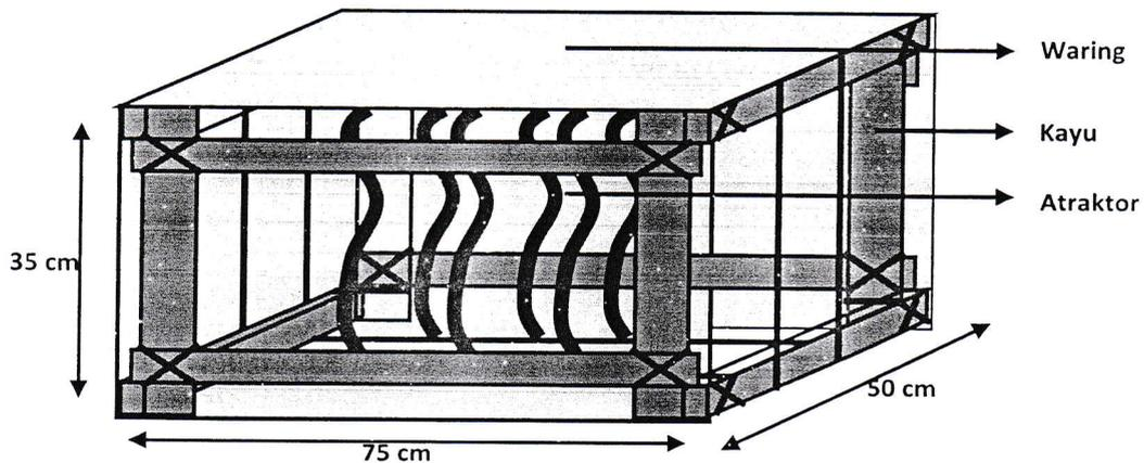
Gambar 3. Desain kotak penutup waring untuk tahap kedua
