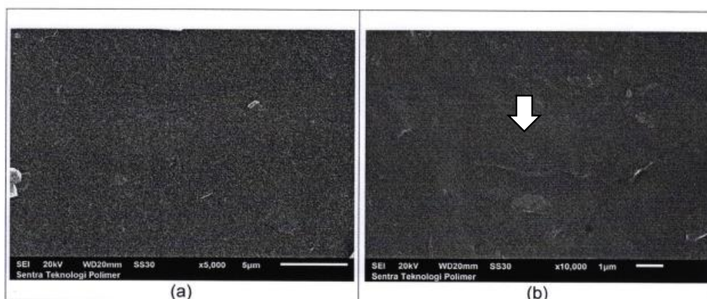
Gambar 6 Foto Morfologi LLDPE pada perbesaran 1000x(a), 2500x(b), 5000x(c), dan 10000x(d)
