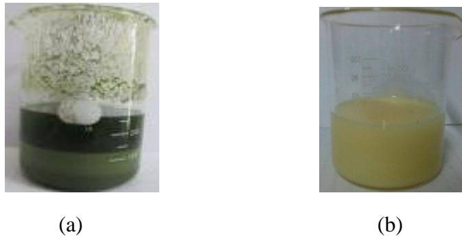
Gambar 2 Visualisasi (a) minyak mikroalga dan (b) minyak epoksidasi untuk pelumas dasar ( based lubricant oil ) dari minyak mikroalga
