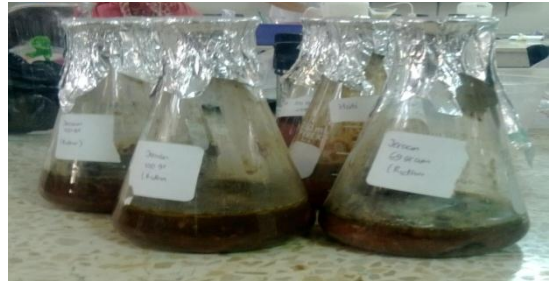
Hasil setelah ekstraksi tulang dengan NaOH (60°C, 2 jam)
