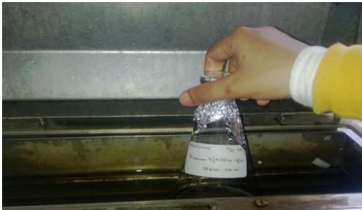
Proses ekstraksi tulang dengan NaOH (60°C, 2 jam)
