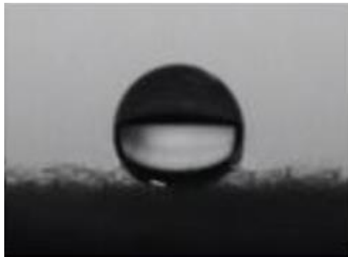
Gambar 5 Bentuk sudut kontak air material tekstil superhidrofilik/superhidrofobik
