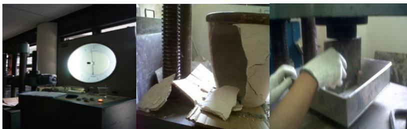
Gambar 3 Universal Testing Machine Shimadzu sebagai *Hidrolic Pressure*, pecahan pot saat uji tekan, dan uji trembesan
