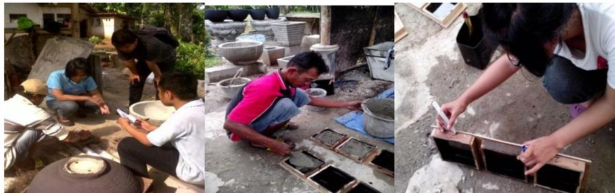
Gambar 1 Pembuatan balok uji struktur dan cetakannya
